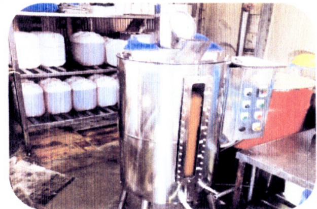
1回に40~50ℓを処理している廃油再生機
